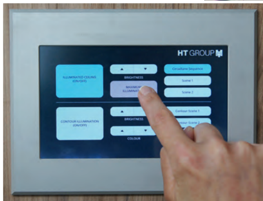
Lichtsteuerung über HT Control Smart, ein DALI Touchpanel mit sieben Zoll großem Display. (Foto: HT Group)
